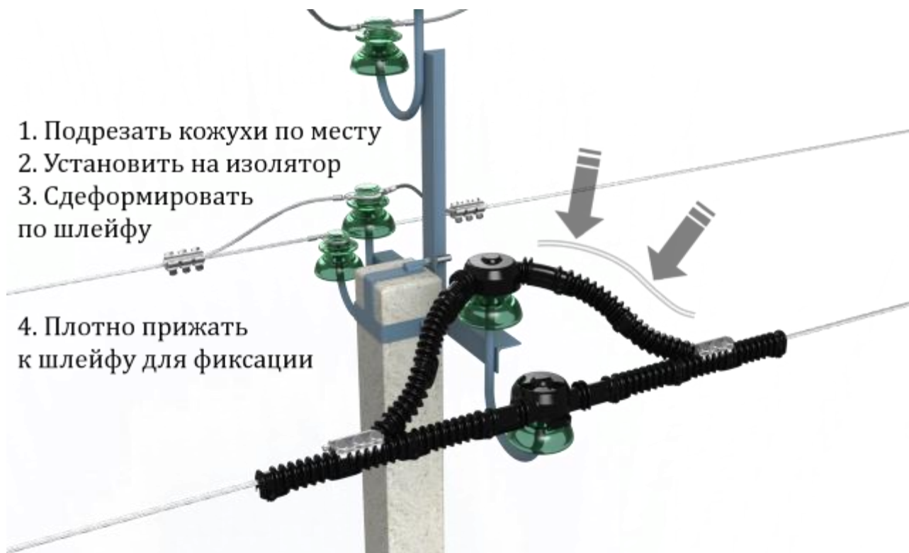
а) установка ПЗУ-6-10кВ-line
